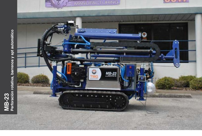
El MB-23 es un equipo de perforación rotativo pequeño, portátil y fácil de usar con un sistema de muestreo de suelo con martillo automático de SPT, que se puede montar en una camioneta, en un remolque o en orugas de goma.
