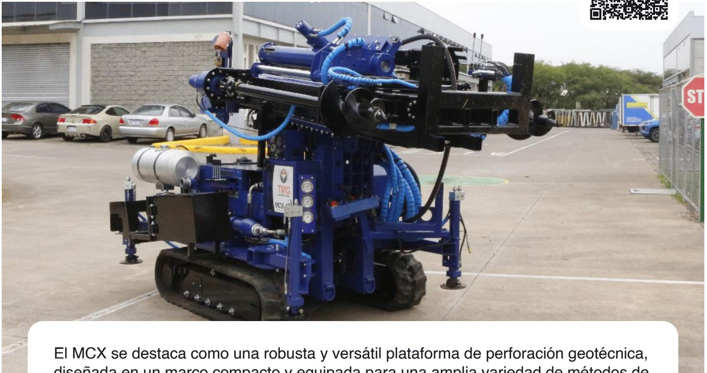
El MCX se destaca como una robusta y versátil plataforma de perforación geotécnica, diseñada en un marco compacto y equipada para una amplia variedad de métodos de perforación.
