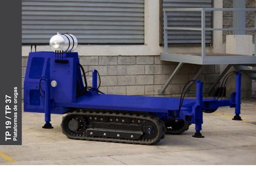
Las plataformas de orugas TP-19 y TP-37 pueden ser usadas para múltiples propósitos, incluyendo conversión a orugas de máquinas perforadoras, transportar tanques de agua, o transporte de herramientas entre otros.
